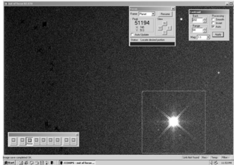
FIGURE 2.4.4. SELECT THE AREA AROUND THE STAR YOU ARE USING FOR FOCUSING, ALLOWING ENOUGH ROOM FOR THE DIFFRACTION SPIKES.
